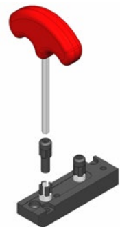
Moving of screw thanks to the extraction set Schrauben Versatz mit Umbau-Set Déplacement de la vis grâce au set d'extraction
